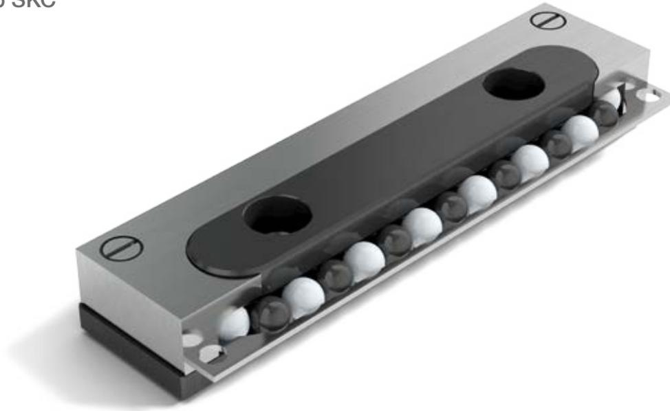
Der Umlaufkörper Typ SKC wurde für Trockenlauf und Anwendungen in Vakuum- und Reinraum entwickelt. Er ist aus DURALLOY® beschichtetem Stahl gefertigt und verfügt über Keramikugeln, welche durch Kugeln aus TEFLON® voneinander getrennt sind.
