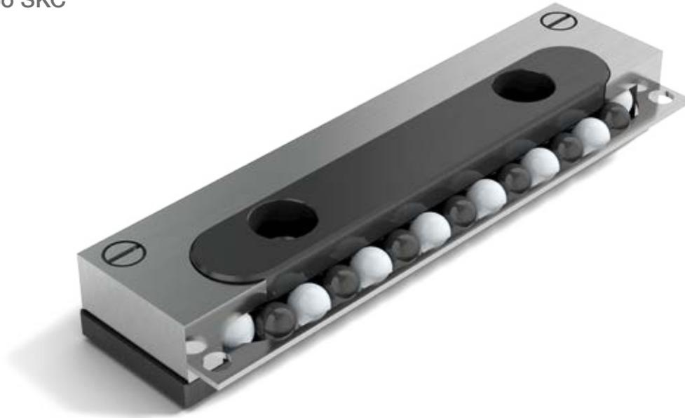
I pattini a ricircolazione tipo SKC sono stati studiati per il funzionamento a secco e per applicazioni sotto vuoto e in camera bianca. Sono in acciaio rivestito in DURALLOY® e dotati di sfere di ceramica intervallate da sfere di TEFLON®.
